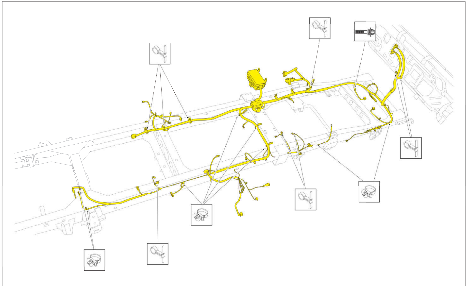
车架前线束 (14035) 安装图
